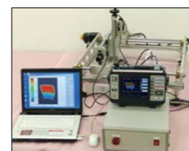
3軸スキャナ装置とPC制御
