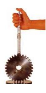
PS-2 は、ワークと接触する先端部分が 鋭角にとがった形状をしています。その ため歯車の歯底 (モジュール3以上) や、 特殊な凹部の硬さ測定ができます。
