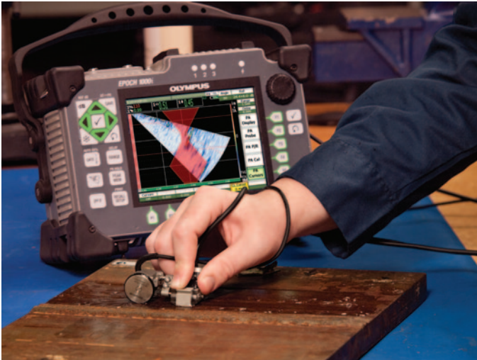
溶接部オーバーレイのあるフェイズドアレイ S- スキャン
