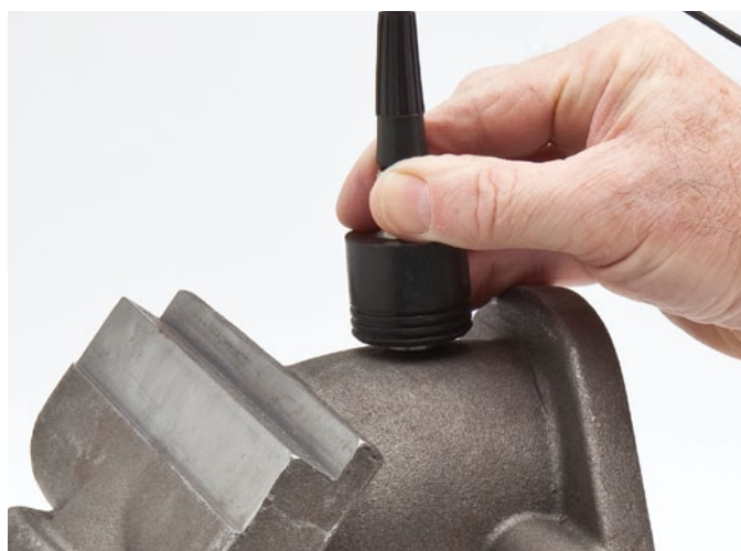
ハイペネトレーションソフトウェアオプションにより、鋳造部品などの超音波減衰材料の肉厚測定が可能
