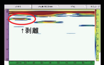
CFRP表面下2mm 剥離検出例
