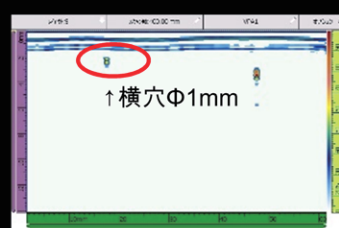
鋼表面下1.5mmΦ1mm 欠陥検出例
