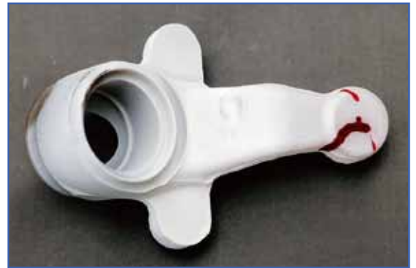
▲タセトカラーチェックによる探傷の一例
